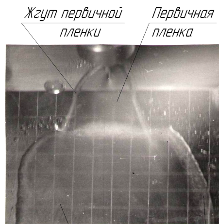
Рис. 3. Растекание вторичной пленки на преграде
