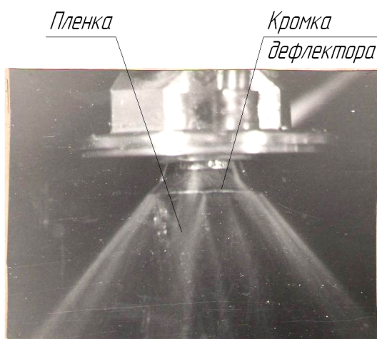
Рис. 4. Первичные пленки, истекающие с кромки дефлектора
