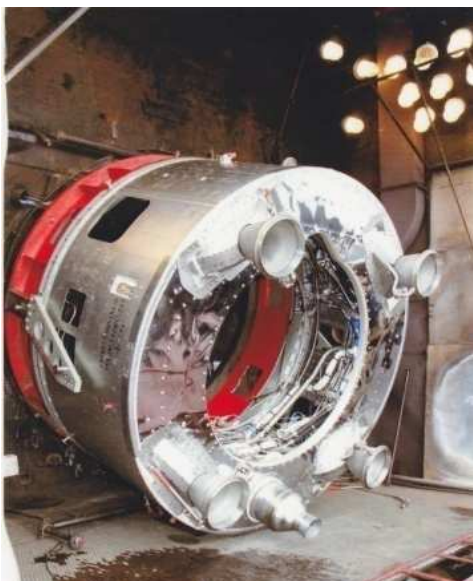
Рис. 4. Доводочный двигатель на огневом стенде
