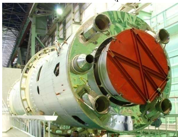
Рис. 3. Двигатель в составе хвостового отсека
