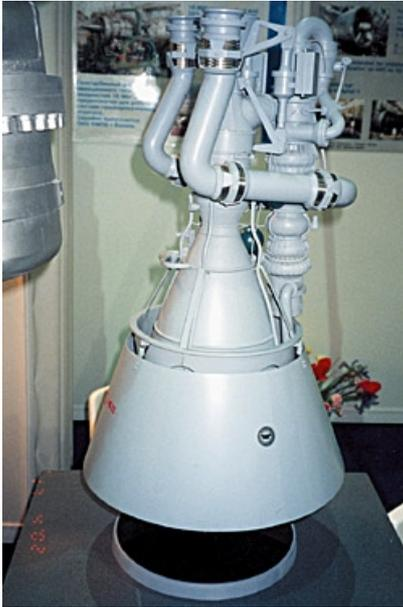
НК-33-1 отличается от прототипа раздвижным сопловым насадком, шарнирным подвесом и входными трубопроводами.
